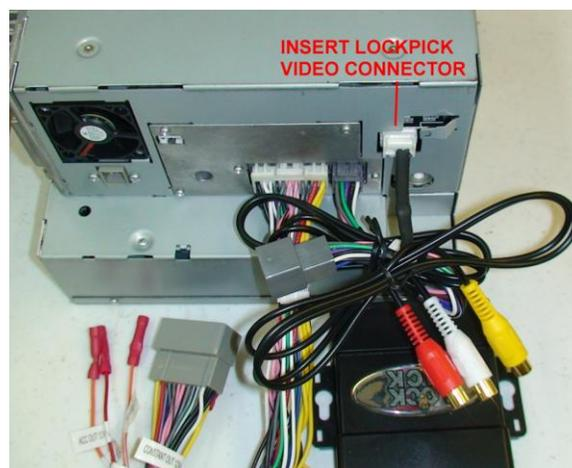
PLUG THE LOCKPICK VIDEO CONNECTOR INTO THE LOCATION SHOWN. IF YOUR RADIO DOES NOT HAVE A VIDEO CONNECTOR, IT IS AN OLDER MODEL REC RADIO AND NOT CAPABLE OF CAMERA/VIDEO INPUT
